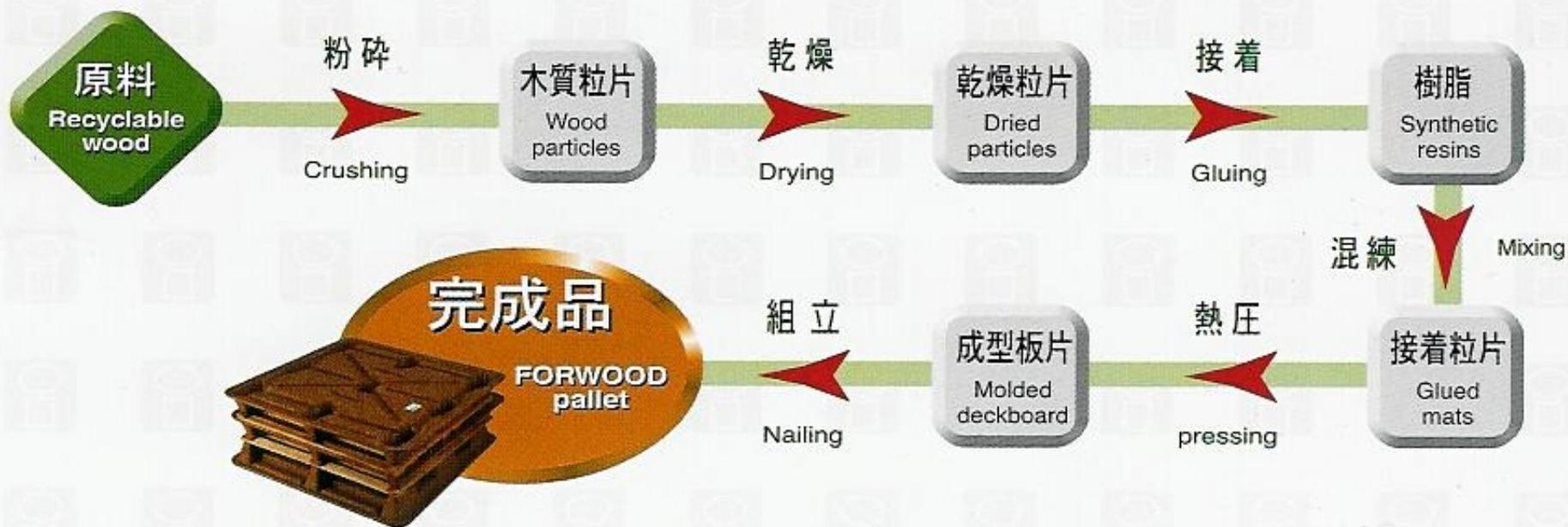
\* 在製造的程序控制中，自原料調和，配料劑量製成型條件等均經由精密的電子儀測座連續監控，以確保穩定的產品品質與高效率的產出。
